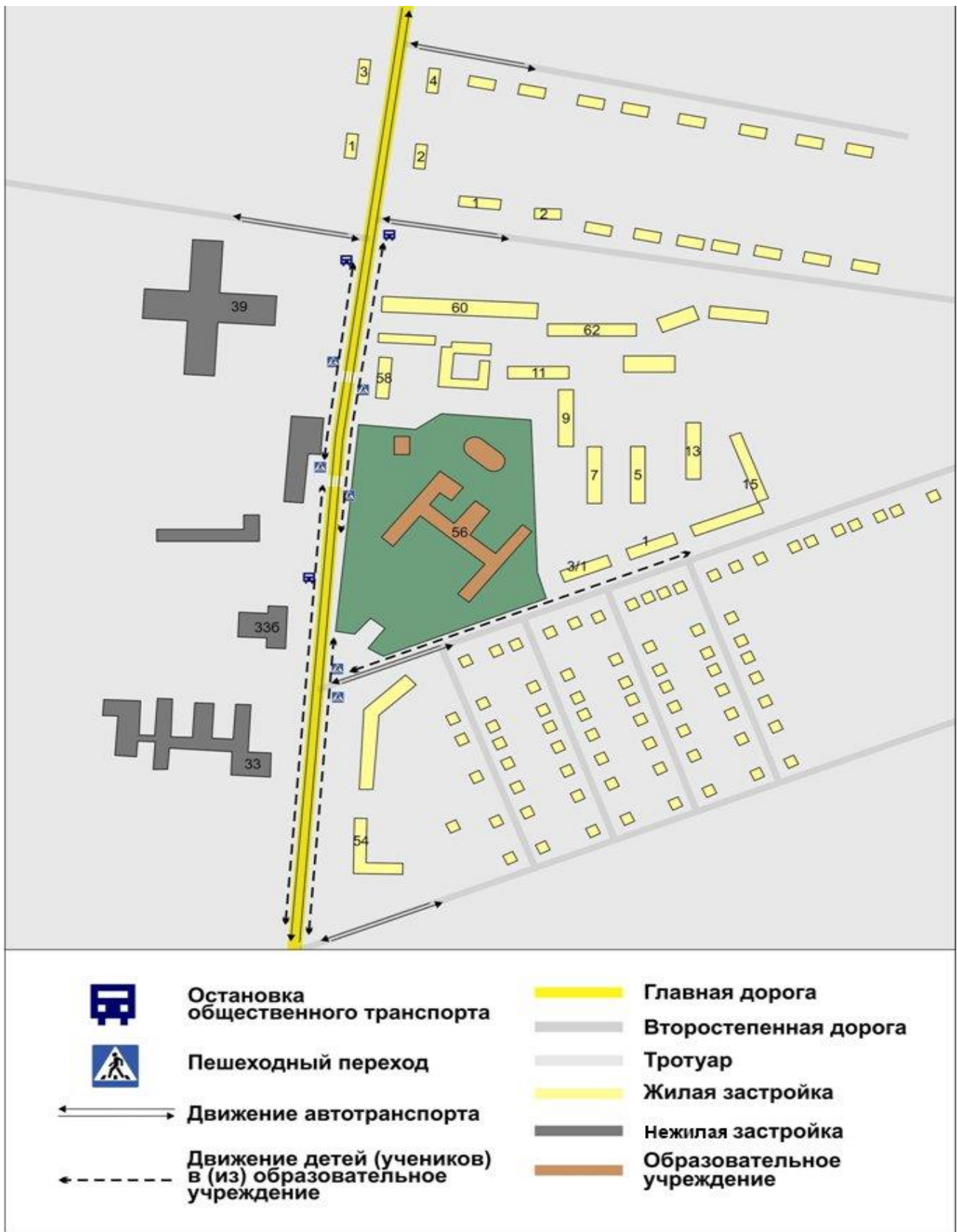
Схема организации движения в непосредственной близости от школы с размещением соответствующих технических средств, расположения парковочных мест
